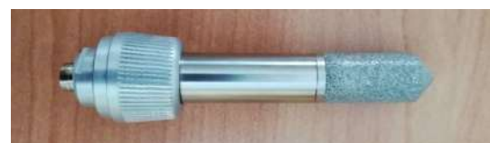
Fig. 5. Sensores de humedad y temperatura
