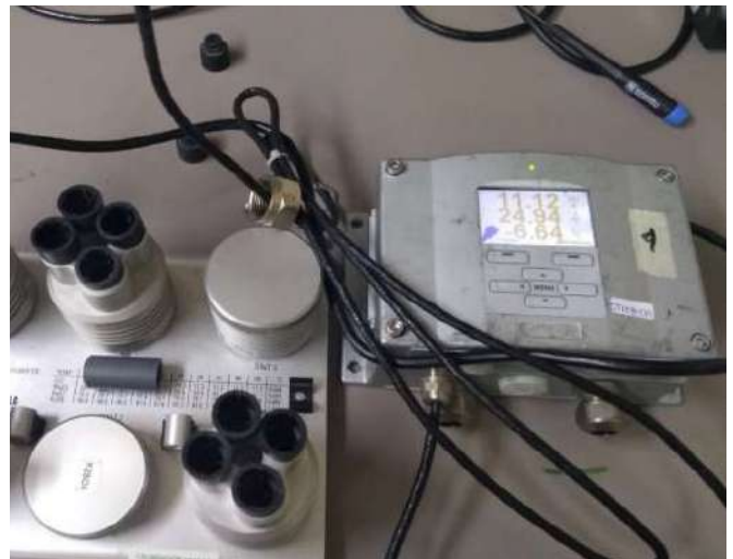
Fig. 3. Calibración de humedad relativa y temperatura
