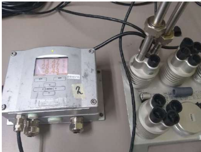
Fig. 3. Calibración de humedad relativa y temperatura
